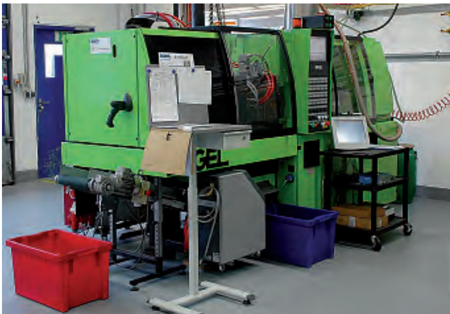
Fertigungszelle Engel Victory 200/45 Tech bei Boida in St. Ulrich am Pillersee.
